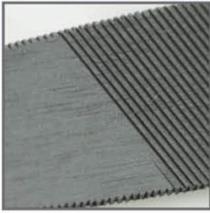
Dientes rectificadas con dureza y geometría homogénea en toda la lima.
