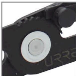
Sistema de matraca que permite asegurar la abrazadera firmemente.
